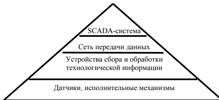
Рис.2. Функциональные уровни управления технологическими процессами
